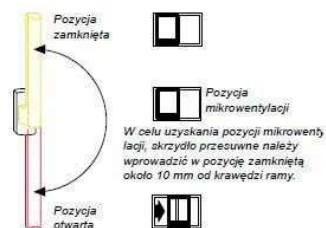
RYŚ. STEROWANIE KLAMKĄ W DRZWIACH BALKONOWYCH THERMO HS I THERMO HS ALU
